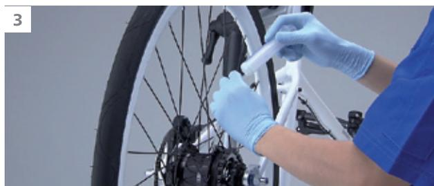
Die Spritze mit vollkommen eingedrücktem Kolben anschließen. Die Ölöffnung muss hierbei immer noch nach oben zeigen.
