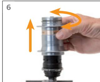
Die Nabenhülse unter ständigem Drehen nach links und rechts nach oben abziehen. Hierbei keine Gewalt anwenden!
