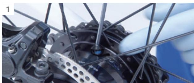
Die Schraube der Ölöffnung mit einem 3-mm-Innensechskantschlüssel entfernen. Die Ölöffnung muss hierbei nach oben zeigen.
