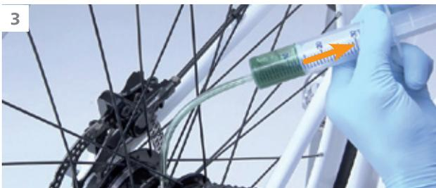
3 Um den Druck im Inneren der Nabe zu verringern, den Kolben in regelmäßigen Abständen etwas herausziehen.
