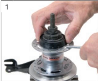
Die beiden abgeflachten Seiten der Nabenachse in einen Schraubstock einspannen. **Hinweis:** Das Gewinde darf nicht beschädigt werden. Vorsichtig die rechte Staubkappe entfernen.
