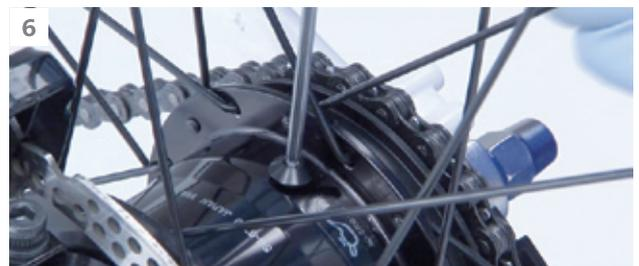
6 Die Schraube der Ölöffnung mit einem 3-mm-Innensechskantschlüssel wieder eindrehen. Anzugsdrehmoment: 2-3 Nm.
