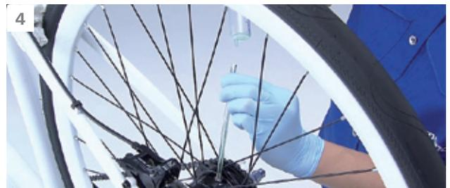
4 Wenn alles Öl aus der Spritze herausgedrückt ist, diese vom Schlauch abnehmen. So läuft das restliche Öl aus dem Schlauch in die Nabe.
