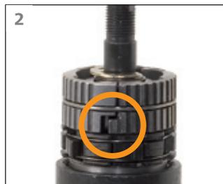
Sicherheitshalber prüfen, dass die Schleiffeder richtig in der Bremschuheinheit positioniert ist.
