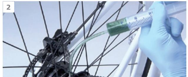
2 Den Entlüftungsnippel mit Schlauch befestigen und die Spritze aufstecken. Den Kolben langsam herunterdrücken, um das neue Öl in die Nabe zu füllen.
