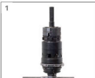
Die beiden abgeflachten Seiten der Nabenachse in einen Schraubstock einspannen. **Hinweis:** Das Gewinde der Achse darf nicht beschädigt werden.
