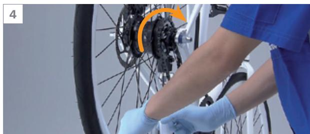
Das Laufrad langsam drehen, bis die Ölöffnung nach unten zeigt.
