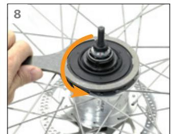
Bei ALFINE 8-Gang-Naben muss das Spezialwerkzeug TL-AF10 zur Befestigung der Staubkappe verwendet werden. Drehrichtung beachten!
