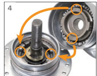
Die Nuten der Bremsarmeinheit und die Verzahnung der Bremschuheinheit aufeinander ausrichten und die Bremsarmeinheit anbringen.
