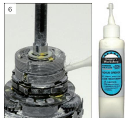
Die Bremschuhe wieder einbauen und mit NEXUS Fett einfetten (Teilenummer: Y-041 20800).
