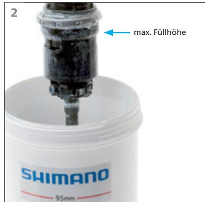
Bei Naben mit Rücktrittbremse muss zuerst die Bremschuheneinheit entfernt werden. Die Nabe mit der linken Seite voran in das Öl eintauchen, bis das Öl die Oberkante der Hohlradeneinheit erreicht.
