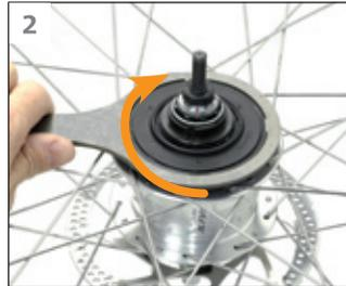
Bei ALFINE 8-Gang-Naben muss das Spezialwerkzeug TL-AF10 zum Entfernen der Staubkappe verwendet werden. Drehrichtung beachten!
