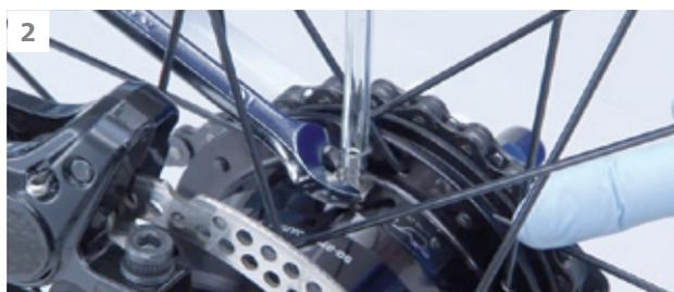
Den Entlüftungsnipl mit dem O-Ring und Schlauch anbringen und mit einem 10-mm-Maulschlüssel festziehen. Anzugsdrehmoment: 1- 3 Nm.
