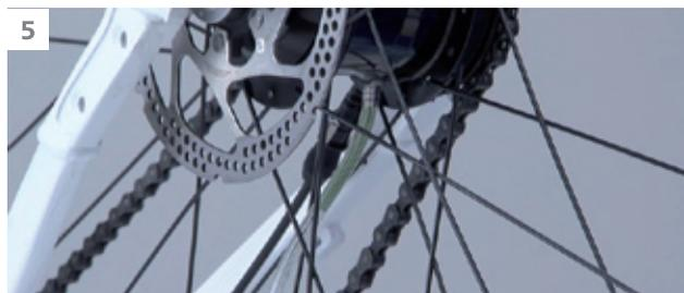
Jetzt 5 Minuten warten, bis sich das Öl unten in der Nabe gesammelt hat. Den Kolben der Spritze langsam ziehen und sämtliches Öl aus der Nabe entfernen.
