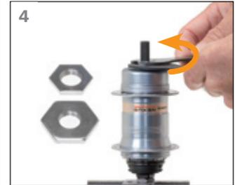
Bei Rücktrittbremsen die 2 linken Muttern entfernen, um die Bremsarmeinheit abzunehmen.
