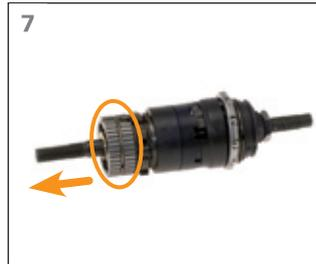
Bei Naben mit Rücktrittbremse muss die Bremschuheinheit vor dem Eintauchen in das Öl entfernt werden.
